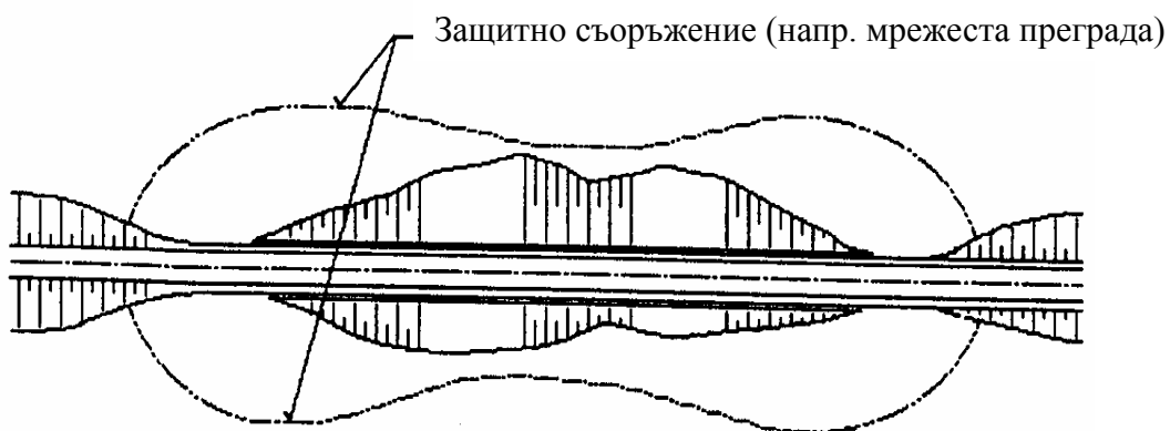
фигура 4: Разполагане на защитни съоръжения срещу образуване на снежни преспи в изкоп.
